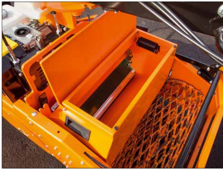
Der Saatgutbehälter fasst bis zu 60 Liter Rasensamen
