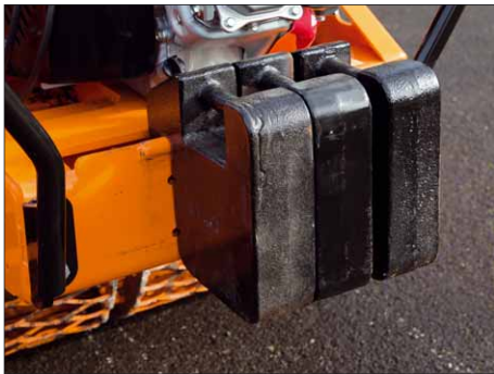
Je nach Untergrund kann es hilfreich sein, die im Zubehör erhältlichen Zusatzgewichte zu montieren
