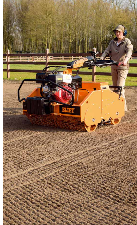
Die Rasenbaumaschine ist zum Anlegen von großen Rasenflächen konstruiert
