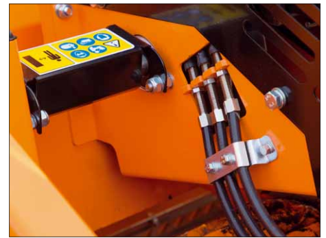
Die hohe Verarbeitungsqualität dieser Maschine wird zum Beispiel an der Verlegung der Hydraulikleitungen deutlich
